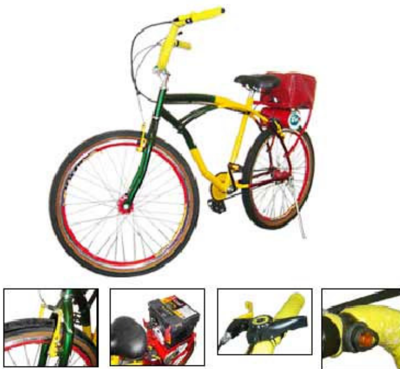
Figura 18: Modelo com motor acima da roda, transmitindo através do aro.
